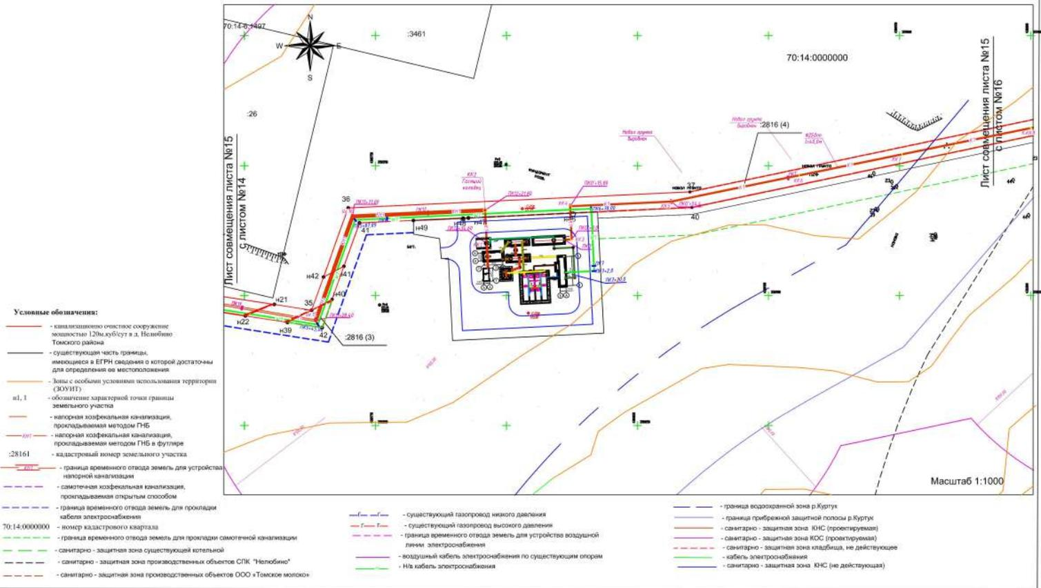
Схема расположения объекта канализационно - очистных сооружений мощностью 120 м<sup>3</sup>/сут в д.Нелюбино Томского района, с показом санитарно - защитных зон, а также зон с особыми условиями использования территории
